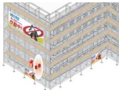
仮設足場侵入警報 システム
