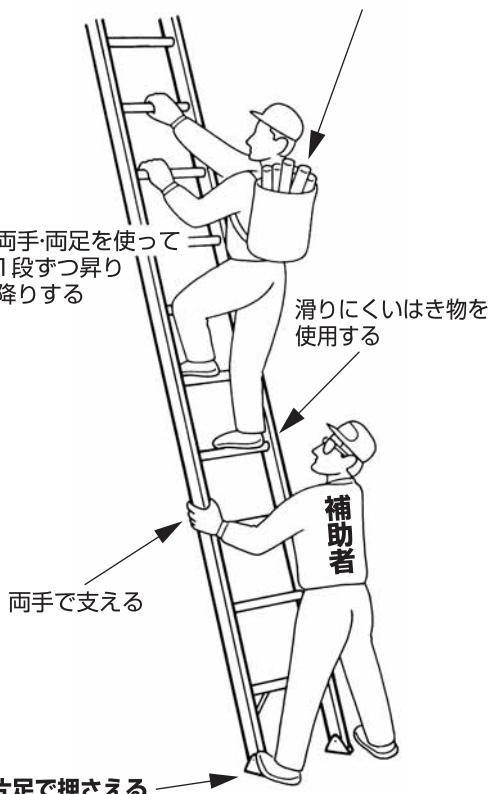
滑り止めユニット(滑り止め用端具)部分を片足で押さえる
