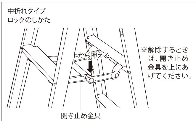
⑤ 脚立を折りたたむときは、開き止め金具のロックを解除したうえで ① ~ ③ の逆の手順で行ってください。
