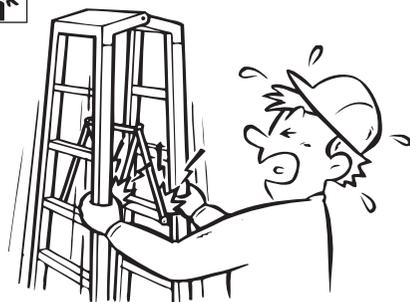
**警告** 脚立を完全に開き、開き止め金具を確実にロックしてください。
